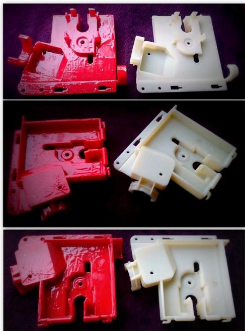
Diseño y fabricación de la reproducción de una pieza de una cisterna para la empresa [www.axiltec.com](http://www.axiltec.com).
