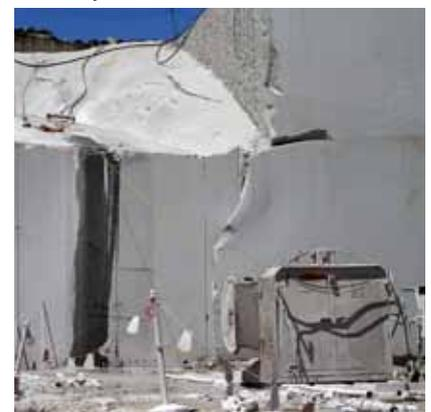
Estabiliza el carro del hilo diamantado, para evitar vuelcos.
