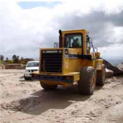
Los dispositivos de advertencia y alarma deben funcionar correctamente: lámpadas giratorias, bocinas, avisador acústico de marcha atrás, frenos, etc.
