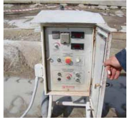
Señaliza la zona de influencia del corte que se va a realizar en las zonas superior e inferior. Prohíbe el acceso a la zona de peligro. Mantén el puesto de control de corte con hilo dentro de la zona segura. Vigila la aproximación de cualquier persona a la zona de riesgo. Comprueba el funcionamiento de la seta de emergencia.
