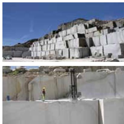
Comprueba el estado del talud y saanea la parte superior y las rocas sueltas. Mantente lejos de la vertical del frente de la cantera, de donde pueden caer piedras.
