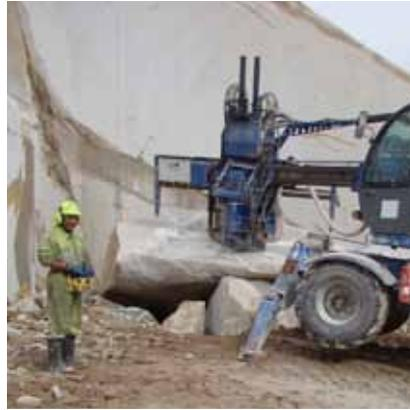
Asegúrate del buen funcionamiento del mando sin hilos y de las setas de parada de emergencia.
