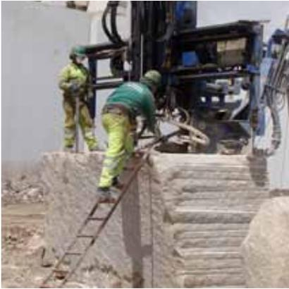
Comprueba el estado del equipo y de los útiles de perforación: mandos, patas estabilizadoras, barras, brocas...
