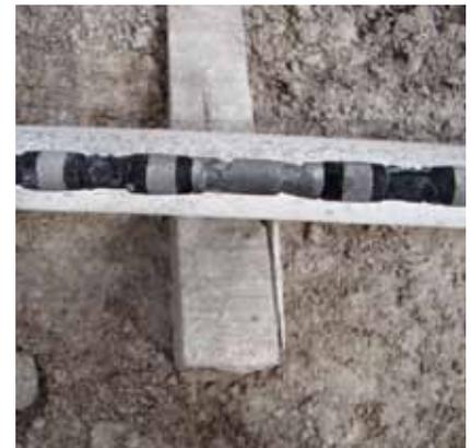
Mantén en buen estado los elementos sustituibles del equipo. Comprueba periódicamente el estado del hilo diamantado y de los empalmes, sustituyéndolos en caso necesario.
